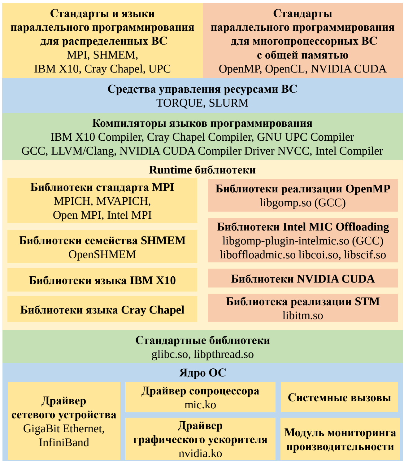
Рисунок 4.2 – Стек программного обеспечения для организации функционирования мультикластерной ВС
